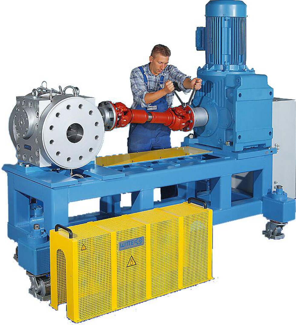
Şekil 1: Redüktörlü motor ile Şase Üzerine oturtulmuş Dişli Pompa EXTRU 716-8
